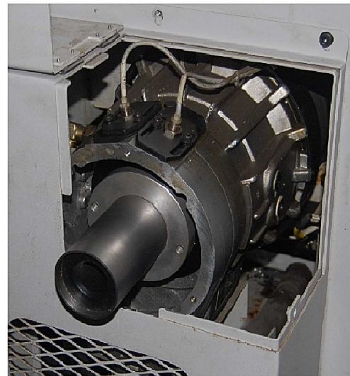
Der Flansch wird mit Schrauben am Schaltring befestigt. Im Foto fehlen noch die Schrauben.
